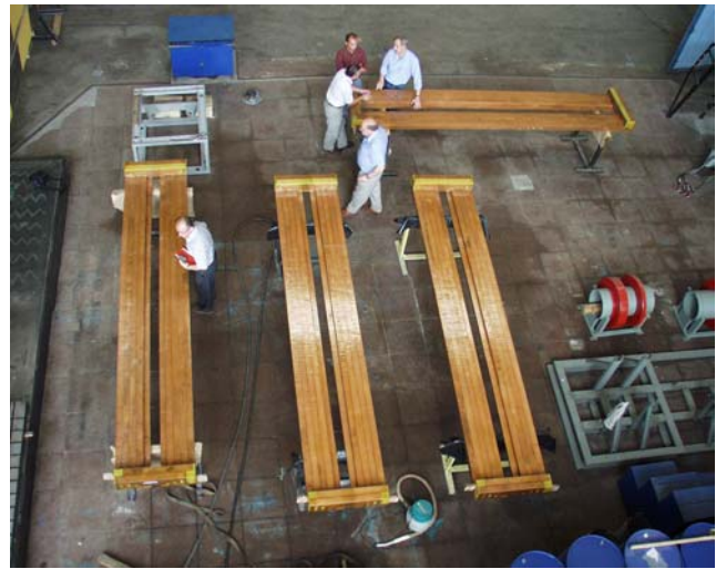
Abbildung 136: BU-Spulen Fertigung beim Efremov-Institut in St. Petersburg.
