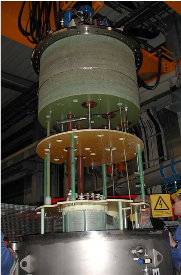
Abbildung 128: Einsatz des SMES-Kryostaten. Am unteren Ende ist die Magnetspule zu erkennen.
