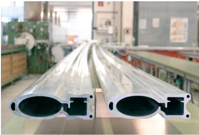
Abbildung 124: Stranggepresste Aluminium Profile für den Einsatz in den PETRA Dipolmagneten. Zu erkennen sind der elliptische Strahlraum mit Abmessungen von 80 \times 40 \text{ mm}^2 , der Seitenkanal für eine NEG-Streifepumpe sowie drei Kanäle für die Wasserkühlung. Die Kammer folgt der Krümmung des Strahlorbits von etwa 200 m Radius.
