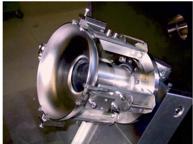
Abbildung 119: Schweißhalterung zur Herstellung einzelner Niob Test Resonatoren in der neuen Elektronen Schweißanlage bei DESY.
